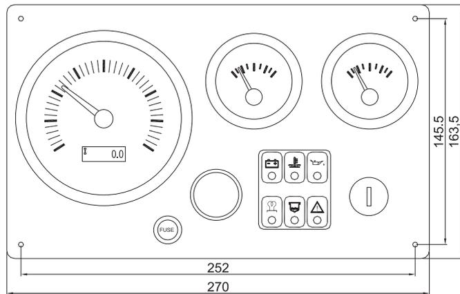
Chiave avviamento, pulsante Start, allarme acustico, indicatori analogici (contagiri, temperatura acqua e pressione olio), display LCD con funzione alternata voltmetro e contaore, spie allarmi (pressione olio, temperatura acqua, preriscaldamento candele, carica alternatore, presenza acqua nel gasolio, allarme generico), fusibile.
