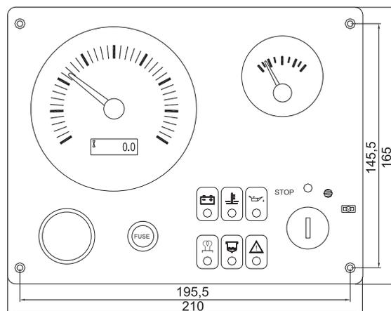
Chiave avviamento, pulsante Start, allarme acustico, indicatori analogici (contagiri, temperatura acqua), display LCD con funzione alternata voltmetro e contaore, spie allarmi (pressione olio, temperatura acqua, preriscaldamento candele, carica alternatore, presenza acqua nel gasolio, allarme generico), fusibile.
