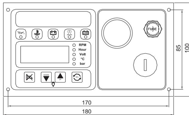
Chiave avviamento, pulsante Start, allarme acustico, indicatore LED (contagiri, contaore, temperatura acqua, voltmetro), spie allarmi (pressione olio, temperatura acqua, carica alternatore, preriscaldamento candele, bassa tensione batteria), fusibile.
